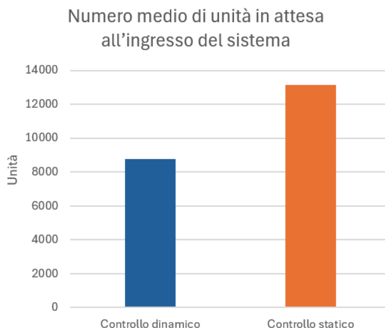
Figura 11: confronto tra la dimensione media della coda di attesa all'ingresso del sistema nei casi CONWIP statico e CONWIP dinamico.
